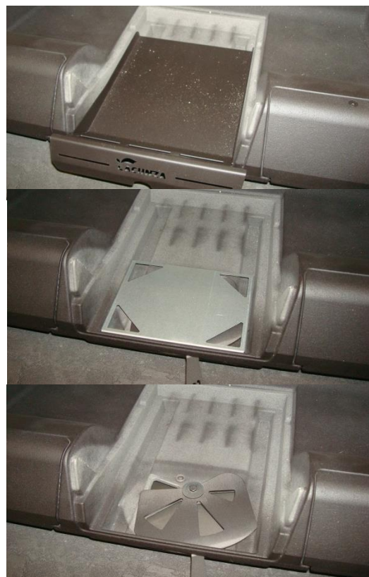
Figura n°25 - Secuencia de desmontaje de piezas para acceder a limpieza
