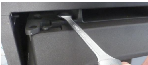
Figura n°10 - Aflojando el soporte de la puerta con llave fija de 10
